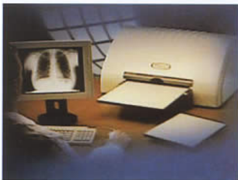
Fig 5 COMPUTER RADIOLOGY compatto da noi adattato e modificato per funzionare con connessione internet senza fili nel pulmino.
